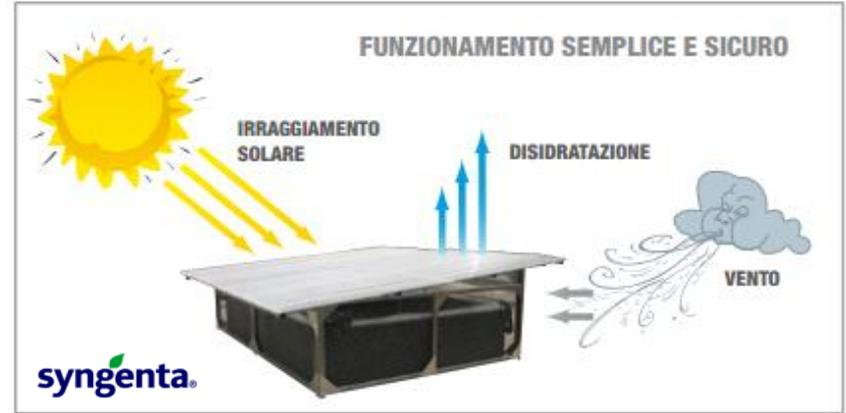
Schema del funzionamento di Heliosec®
